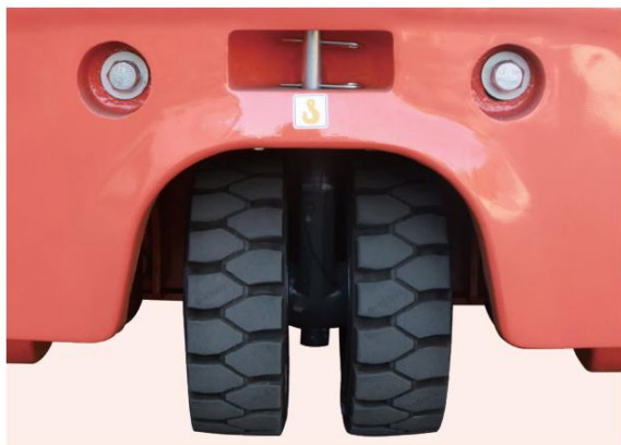
Die Hinterräder wurden von den ursprünglichen 15x4 1/2-8 Reifen auf 140/55-9 Reifen aufgerüstet, um ihre Tragfähigkeit zu erhöhen.
